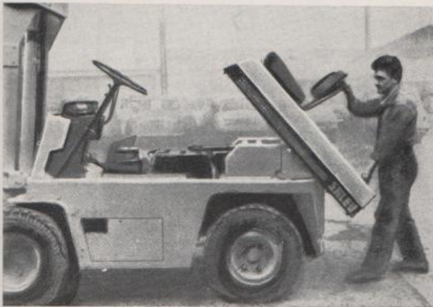
6. В последней модели капот откидывается назад.
